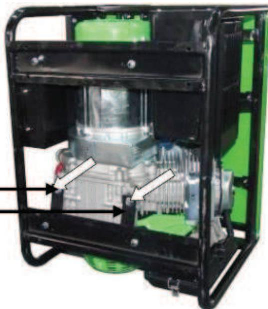
2. Установите резиновые опоры на раму генератора и с помощью гайки (M8) зафиксируйте их.
